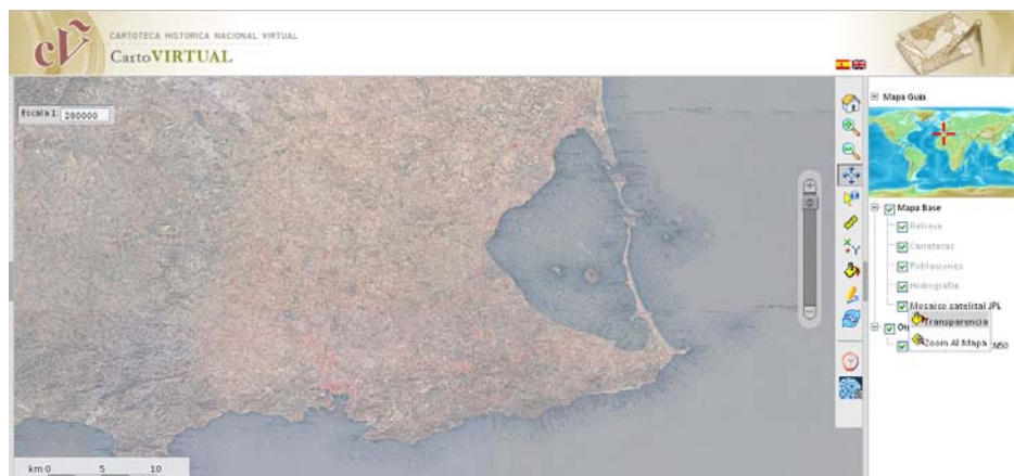
Fig. 6: Combinación de otras capas WMS: superposición de la Primera Edición del MTN50 del IGN con el mosaico satelital del JPL de la NASA
